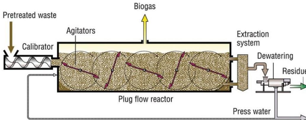
**Fig 11 Schematic of Plug Flow Reactor (Strabag-Umweltanlagen GmbH)**
